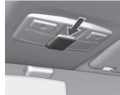
Hay un portador de boletos de estacionamiento en la parte media de las luces de lectura y los interruptores. Para usarlo, jálelo hacia abajo y coloque el boleto adentro.
