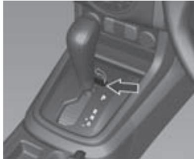
2. Abra la cubierta a la derecha de la palanca selectora.
