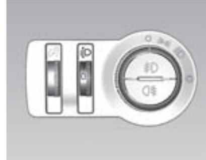
Para adaptar el rango de los faros delanteros a la carga del vehículo para prevenir deslumbramiento, gire la perilla a la posición que se necesite.
