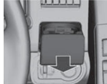
Los portavasos extensibles se ubican debajo de cada toma de aire ajustable al lado del tablero de instrumentos. Jale para abrir.
