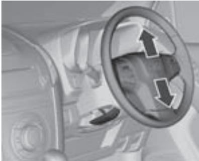
Desbloquee la palanca para ajustar el volante, después enganche la palanca y asegúrese de que esté totalmente bloqueada.
