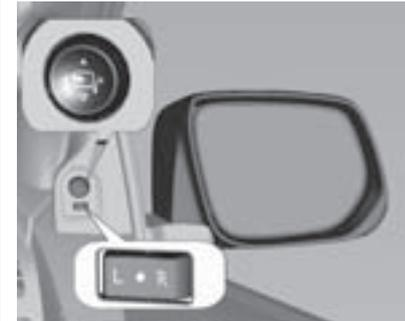
Los controles de los espejos eléctricos se encuentran en el aleta de tiburón junto al conductor.
