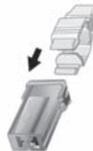
Coloque el extractor de fusibles en los diferentes tipos de fusibles de la parte superior o lateral, y retire el fusible.
