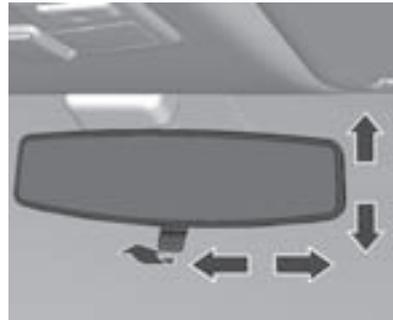
El ajuste se realiza inclinándolo a una posición adecuada.
