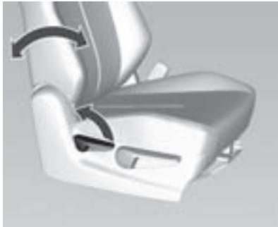
Jale la palanca, ajuste la inclinación y suelte la palanca. Permita que se escuche que el asiento engancha.
