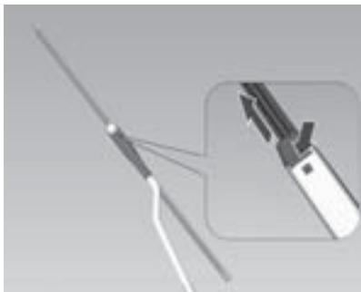
1. Sostenga la varilla del limpiaparabrisas brazo y levante el brazo del limpiaparabrisas.
