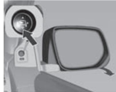
Oprima el interruptor selector (interruptor L / R) hasta la posición central, • a continuación oprima el interruptor de cuatro vías. Ambos espejos exteriores se plegarán.
