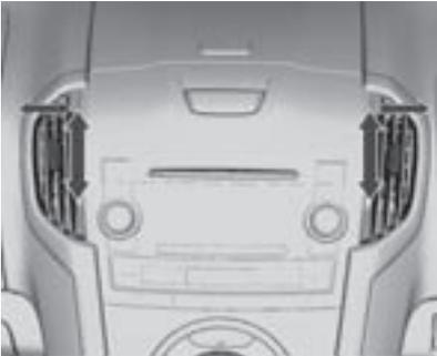
Empuje las rejillas hacia arriba para abrir y hacia abajo para cerrar la toma de aire o para ajustar la cantidad de aire.
