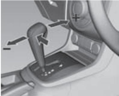
Mueva la palanca selectora fuera de la posición **D** hacia la izquierda y a continuación hacia adelante o hacia atrás.
