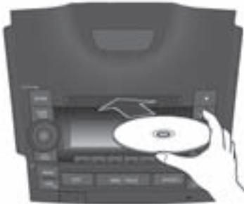
Inserte el disco que desea reproducir con la superficie impresa hacia arriba en la ranura de inserción de disco.
