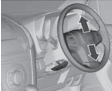
Desbloquee la palanca, ajuste el volante, después enganche la palanca y asegúrese que esté totalmente bloqueada.
