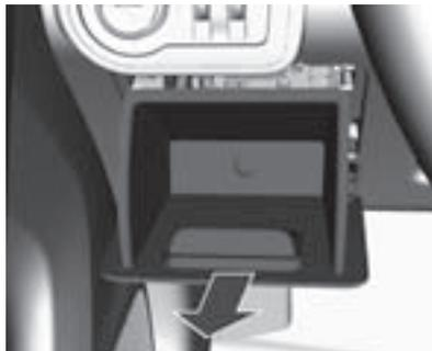
3. Levante el compartimiento de almacenamiento hasta que se libere y se retire audiblemente en la dirección de la flecha.
