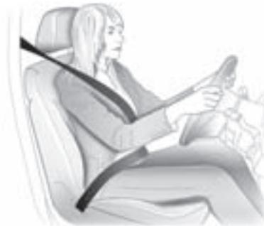
Extraiga el cinturón de seguridad y fíjelo dentro del cierre. El cinturón de seguridad no debe estar retorcido y debe quedar bien ajustado al cuerpo dentro del cierre. El respaldo no debe estar demasiado reclinado (máximo aproximado 25°).
