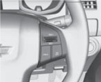
El sistema de control de velocidad de cruceo se puede operar por medio de los controles del volante.
