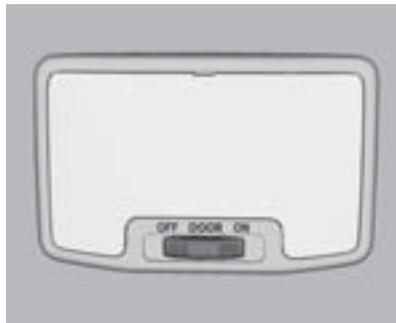
Al entrar o salir del vehículo, las luces de cortesía se encienden automáticamente y, después de una breve periodo de tiempo, se apagan nuevamente. Se encienden por un tiempo corto, incluso si la llave se retira de la cerradura de ignición.
