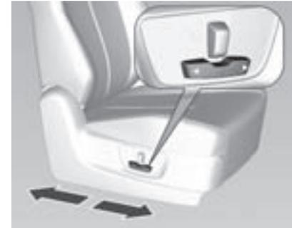
La posición se puede ajustar moviendo el interruptor hacia adelante o hacia atrás.
