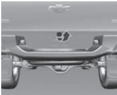
2. Remueva la cubierta para insertar el extremo afilado de la manija del gato en un ligero ángulo a través del agujero central en la defensa trasera y en la guía en forma de embudo.
