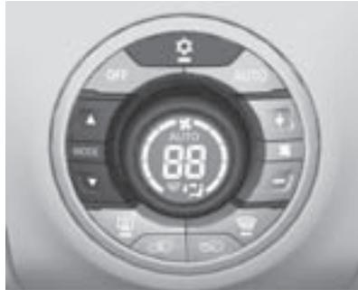
Presione el botón **MODE** una vez o más para el ajuste que desee, la configuración de la distribución del aire se indica en la Pantalla de información.
