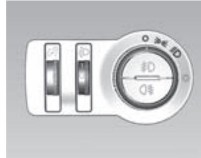
El brillo de las siguientes luces se puede ajustar cuando las luces exteriores se encienden:
