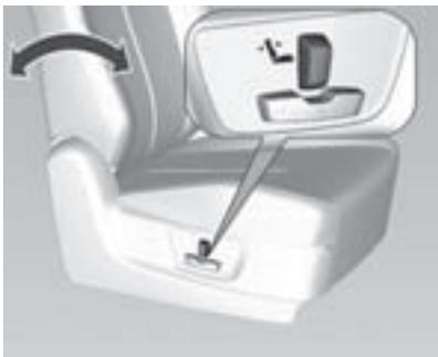
El respaldo se puede ajustar moviendo el interruptor hacia delante o hacia atrás.
