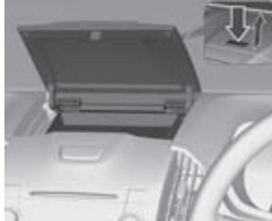
Presione el botón para abrir el almacenamiento superior del tablero de instrumentos.
