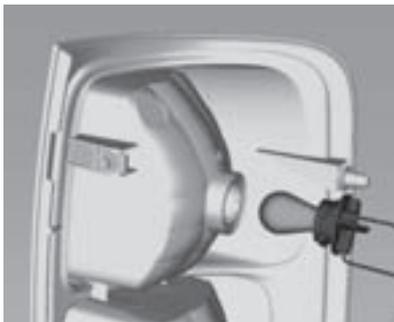
5. Retire el soporte del foco. Empuje el foco dentro del enchufe ligeramente, gire en sentido contrario al de las manecillas del reloj y retire el foco.
