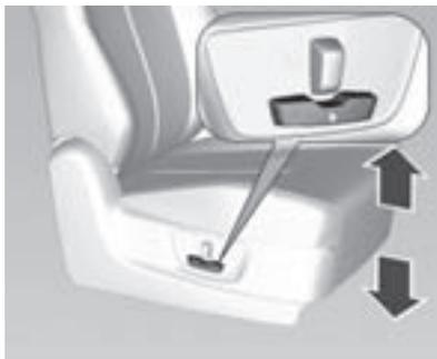
La altura se puede ajustar moviendo el interruptor hacia arriba y hacia abajo.
