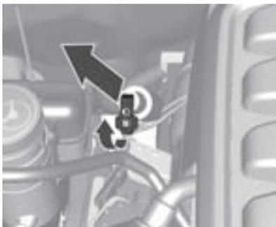
Para verificar el nivel del aceite de la transmisión automática extraiga la varilla del nivel, límpiela, insértela hasta el tope del mango. Extráigala y lea el nivel del aceite.
