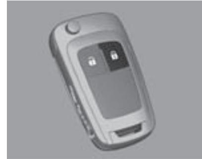
El sistema de alarma antirrobo se activa por medio del control remoto del radio:
