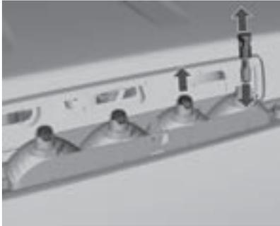
2. Jale el enchufe del foco para retirarlo del ensamble de la lámpara.
