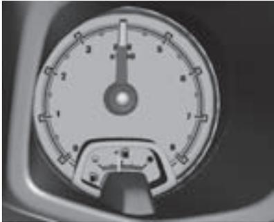
Proyecta las revoluciones por minuto del motor (rpm).
