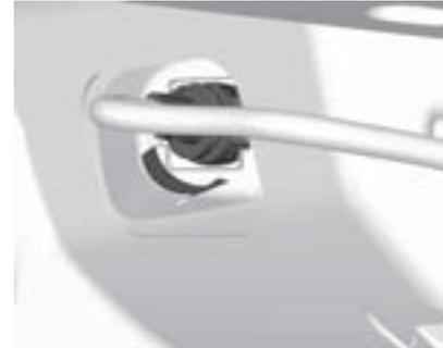
2. En la parte posterior de la defensa, gire el soporte del foco en sentido contrario al de las manecillas del reloj para desenganchar.
