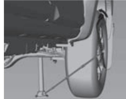
Si la llanta pinchada se encuentra en la parte trasera, coloque el gato debajo del eje trasero, tan cerca del amortiguador como sea posible.
