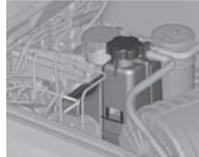
Si el sistema de enfriamiento está frío, el nivel del refrigerante debería estar 2.5 cm por encima de la línea de la marca de llenado. Rellene si el nivel está bajo.
