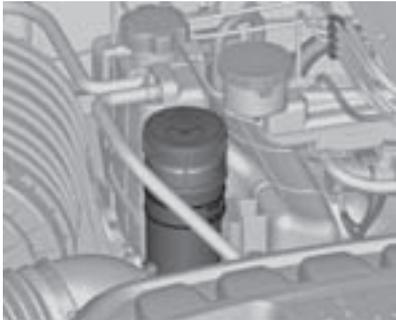
El nivel del fluido la dirección hidráulica debe estar entre las marcas **MIN** y **MAX**.
