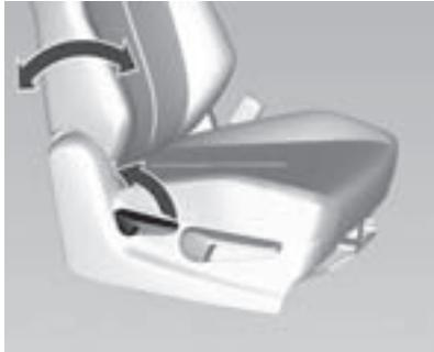
Jale la palanca, ajuste la inclinación y suelte la palanca. El asiento se debe bloquear en su lugar.
