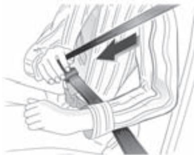
Extraiga el cinturón del carrete, guíelo sin retorcer de un extremo al otro del cuerpo y enganche la placa de cerrojo a la hebilla. Tense el cinturón de seguridad de dos puntos mientras conduce jalando del cinturón del hombro.
