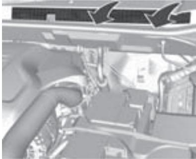
La admisión de aire en la parte delantera del parabrisas en el compartimento del motor se debe mantener limpia para permitir la entrada de aire. Retire las hojas, suciedad o nieve.
