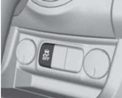
El Control de tracción se puede apagar cuando se requiera el deslizamiento de la rueda de tracción: presione el botón
