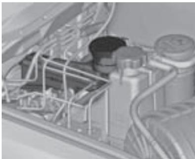
El nivel del fluido de frenos debe estar entre las marcas **MIN** y **MAX**.
