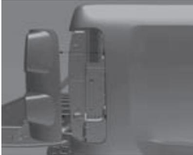
2. Retire el ensamble de la luz trasera jalándolo hacia fuera de la carrocería. Tenga cuidado de que el ducto del cable se mantenga en su posición.
